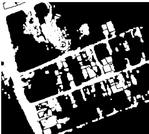
Figura 7 – Resultado do processo de abertura aplicada à imagem binarizada.
