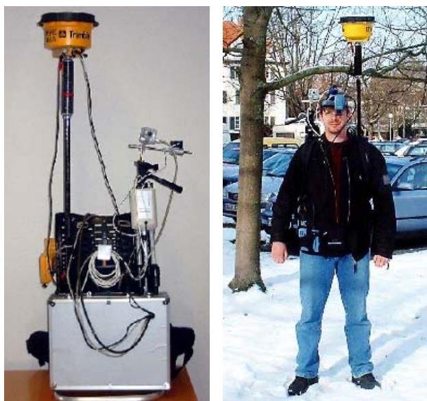
a) Unidades de apoio, GPS e sistema inercial montados b) Unidade móvel com óculos e unidades de apoio
